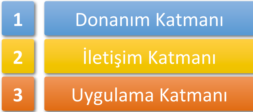
Görsel 1.32: Üç katmanlı IoT mimari modeli
