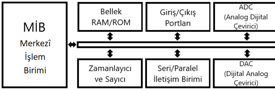
Görsel 2.24: Mikrodenetleyici iç yapısı
