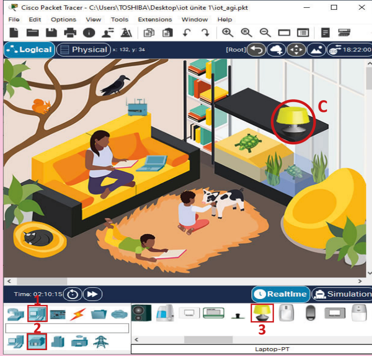
Görsel 1.8: Light IoT cihazının yerleşimi
