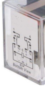
Görsel 3.41: Röle bobin ve kontak bağlantısı
