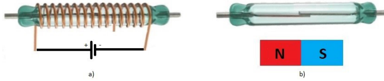
Görsel 3.35: a) Çubuk röle bobin bağlantısı
