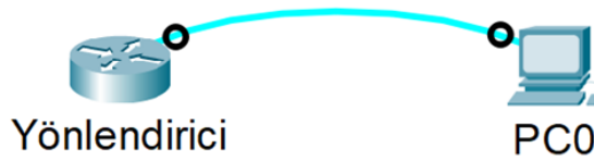
Görsel 3.3: Yönlendiricinin konsol kablosu ile bağlantısı
