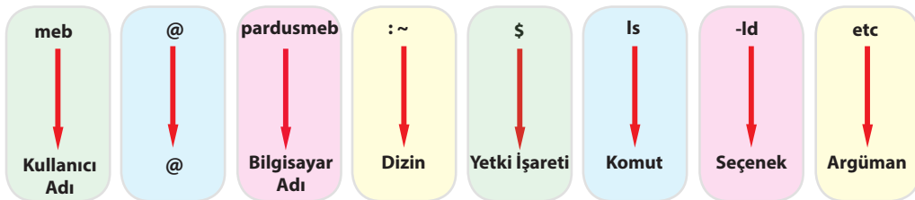
Şekil 4.1: Açık kaynak işletim sisteminde komut satırı yapısı
