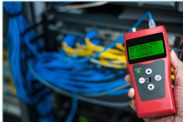
Görsel 2.6: Dijital kablo test cihazı ve kullanımı
