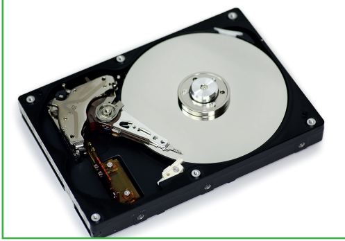
Görsel 3.24: Manyetik diskli sabit sürücü iç yapısı
