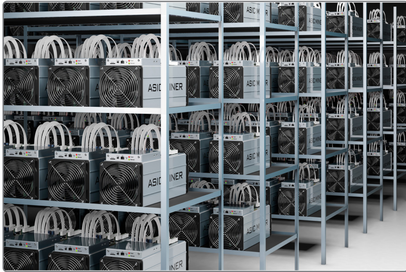
Görsel 1.9: ASIC sistemi ile madencilik ekipmanı
